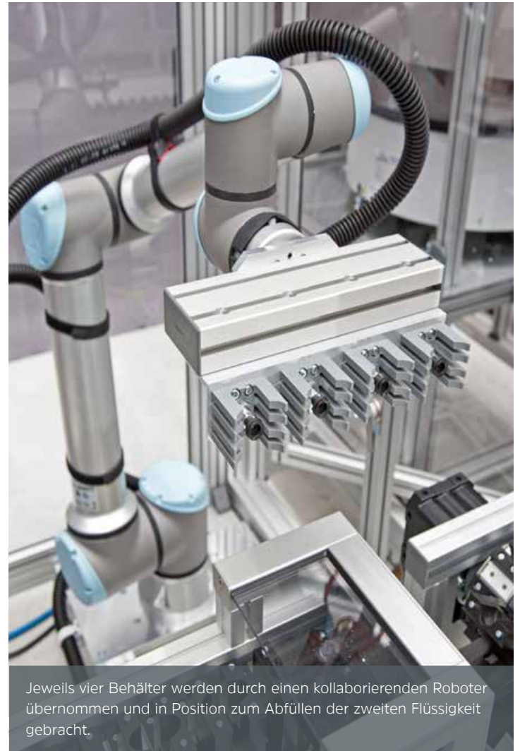
Die Dosierung und die Verschraubung mit Deckel erfolgt zeitgesteuert; ein Kamerasystem mit Orientierungserkennung stellt die korrekte Lage sicher.
