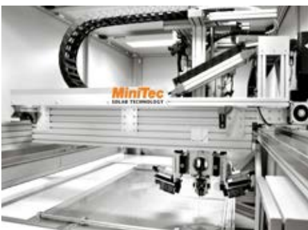
Die Laserschweißanlage ist eine vollautomatische Anlage mit moderner CNC-Steuerung.
