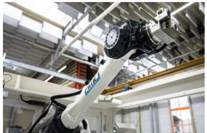
Ein Yaskawa 6-Achsroboter unterstützt beim Beladen der CNC-Maschine.
