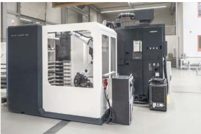
Seit kurzem in Betrieb: Eine Roboterzelle für die automatische Werkstückbeladung einer vorhandenen CNC-Maschine
