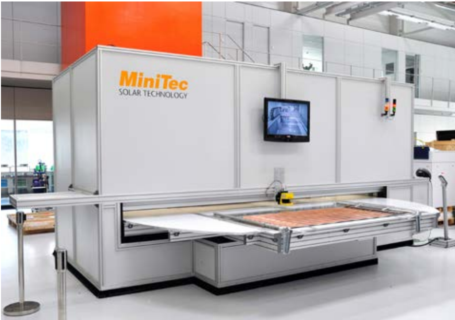
Die Laserschweißmaschine ermöglicht eine effiziente, sichere und kostengünstige Absorber-Produktion auch im Mehrschichtbetrieb.
