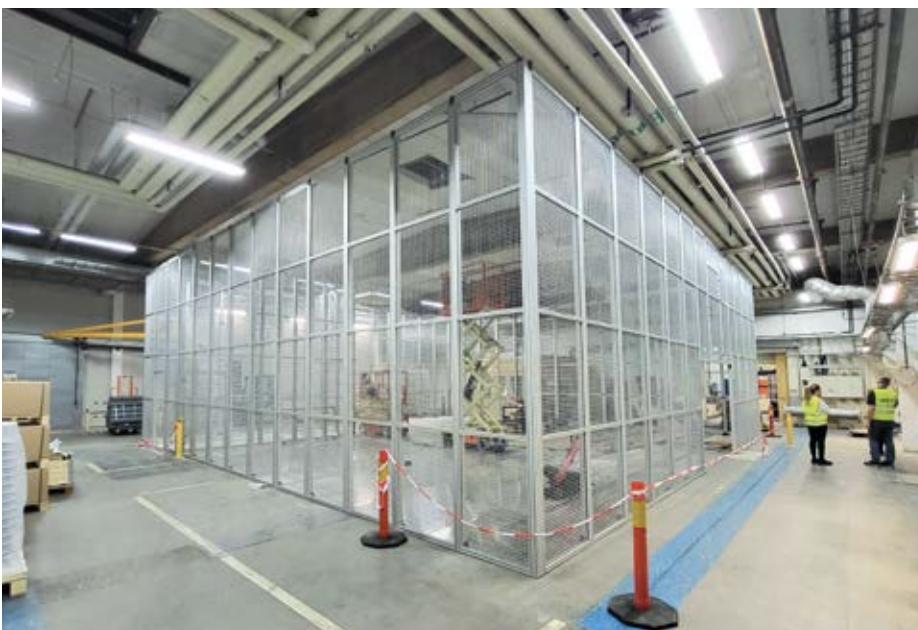
Aus dem MiniTec-Baukasten: XXL-Schutzzeinhäusung für eine Anlage zur Überprüfung von Unterseekabeln auf eventuelle Schäden.
